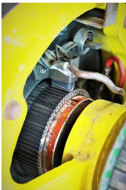
รูปที่ 5.7 ลักษณะการติดตั้งแปรงถ่านและชุดยึดแปรงถ่าน
