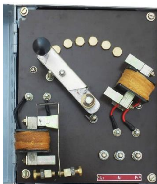
(ข) โครงสร้างภายในของชุดเริ่มเดินมอเตอร์
